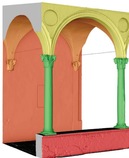
Figura 5 Modello mesh del claustro porticato (a sinistra) e modello tipologico segmentato (a destra).
