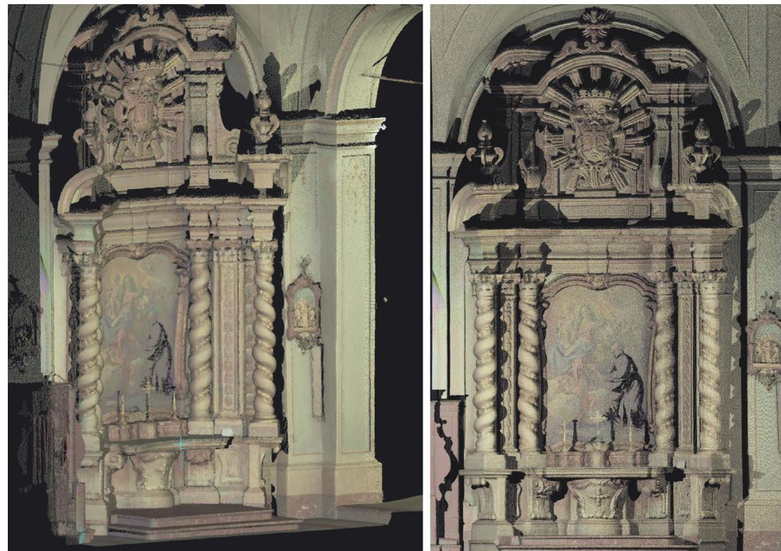
Fig. 01 Rilievo laser scanner, altare di San Gaetano da Thiene; chiesa San Paolo Apostolo, Palazzolo Acreide (Sr).
