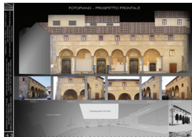
Fig. 24. Rilievo dei prospetti principali dell'Ospedale di Sant'Antonio a Lastra a Signa. Fotopiani [12]. All'interno di questo edificio Vittorio Bellini nel 1828 ricava una sala teatrale per l'Accademia dei Risoluti.
