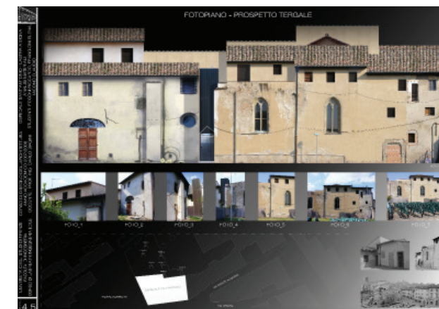
Fig. 24. Rilievo dei prospetti principali dell'Ospedale di Sant'Antonio a Lastra a Signa. Fotopiani [12]. All'interno di questo edificio Vittorio Bellini nel 1828 ricava una sala teatrale per l'Accademia dei Risoluti.
