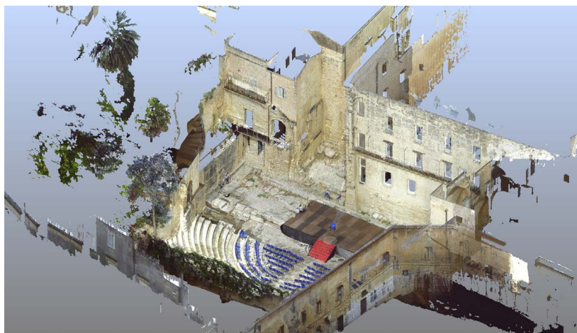
Fig. 5 . a) In alto viste tridimensionali del rilievo di Sanner Laser 3D del Teatro romano di Lecce. b) In basso a sinistra pianta del teatro ottenuta dal laserscan 3D con sovrapposto il disegno in CAD. c) In basso a destra la pianta del teatro.
