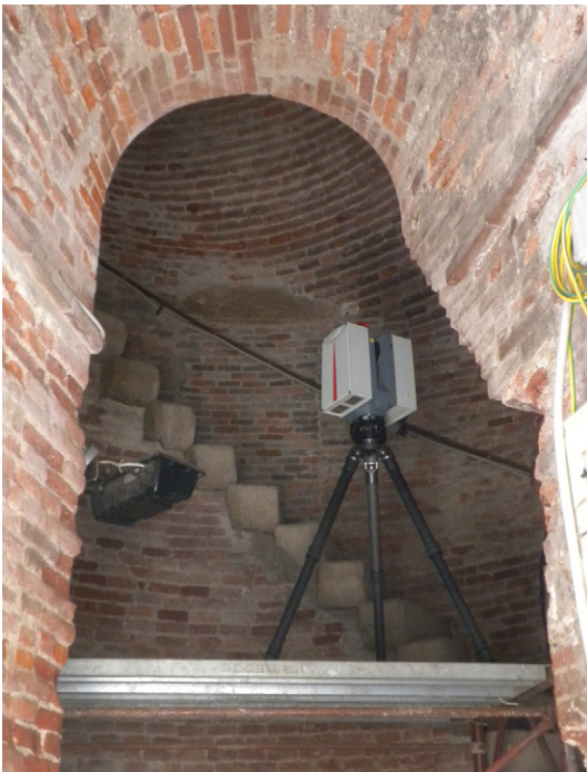
Fig. 6. La ripresa con scanner laser.
