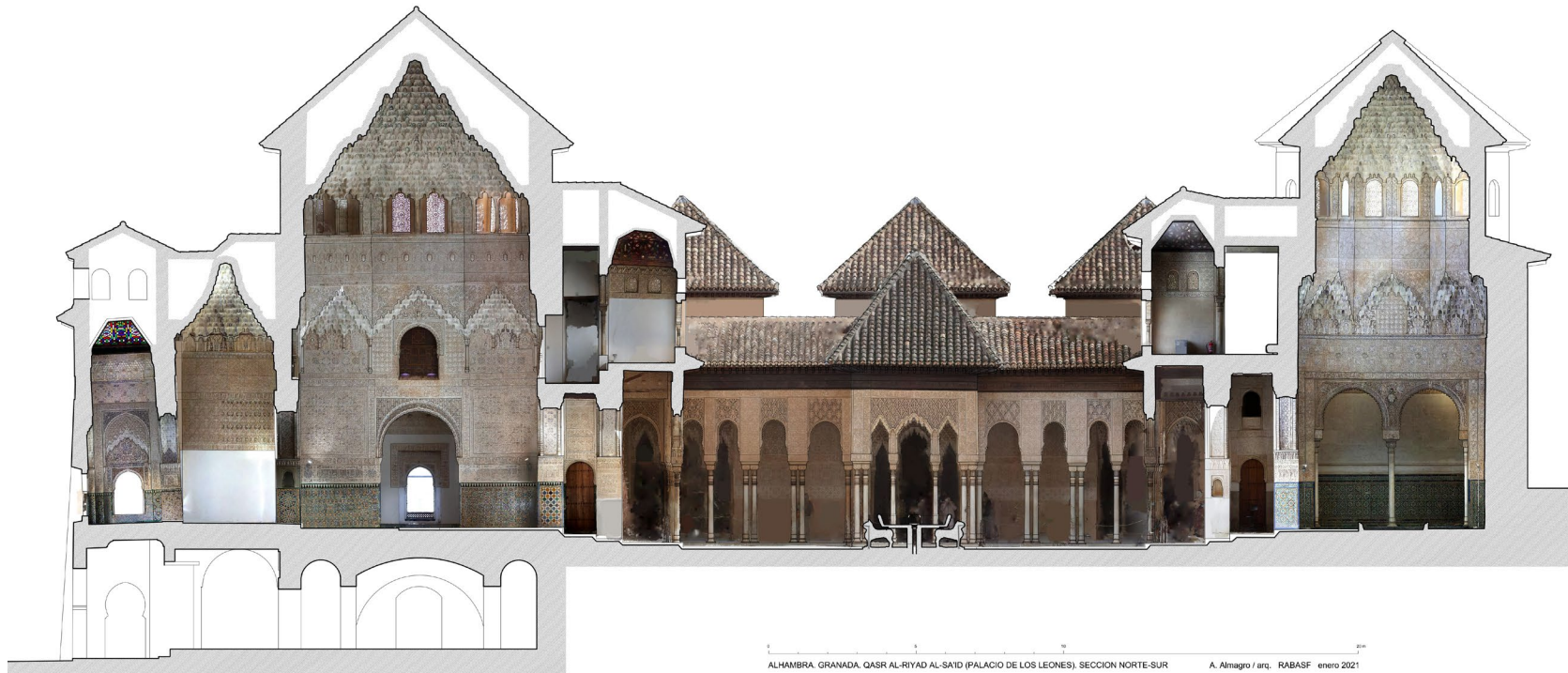
Fig. 1 - Section with orthophoto of the Palacio de los Leones , Alhambra of Granada (Spain) (Antonio Almagro Gorbea).
