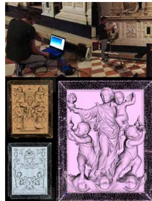
Fig. 8: Rilievi strumentali eseguiti tramite Scanner 3D Artec Eva: foto di campagna ed elaborazioni di alcune scansioni delle formelle della Santa Casa.
