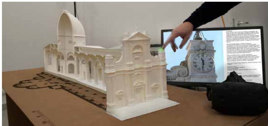
Fig. 13: L'esperienza tattile attraverso il modello fisico interrogabile: i sensori di prossimità consentono la fruizione di contenuti multimediali attivabili con un semplice tocco del modello.
