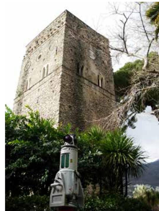
Fig. 2. Fasi di rilievo tridimensionale mediante scanner Riegli LMS-Z420i
