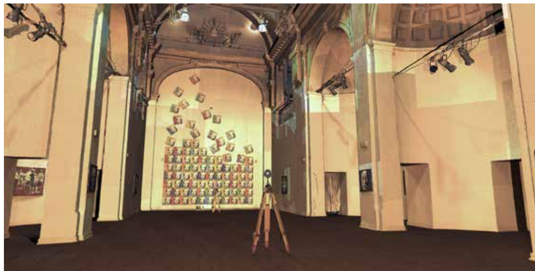
Fig. 3. Snapshot delle nuvole di punti ricavate tramite rilievo scanner laser dell'interno della ex-chiesa di San Ludovico, ora adibita a galleria espositiva per mostre temporanee.
