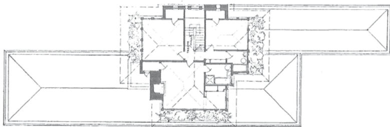
Fig.22 – Robie House, Chicago. Planimetria del secondo livello con la proiezione delle coperture.
