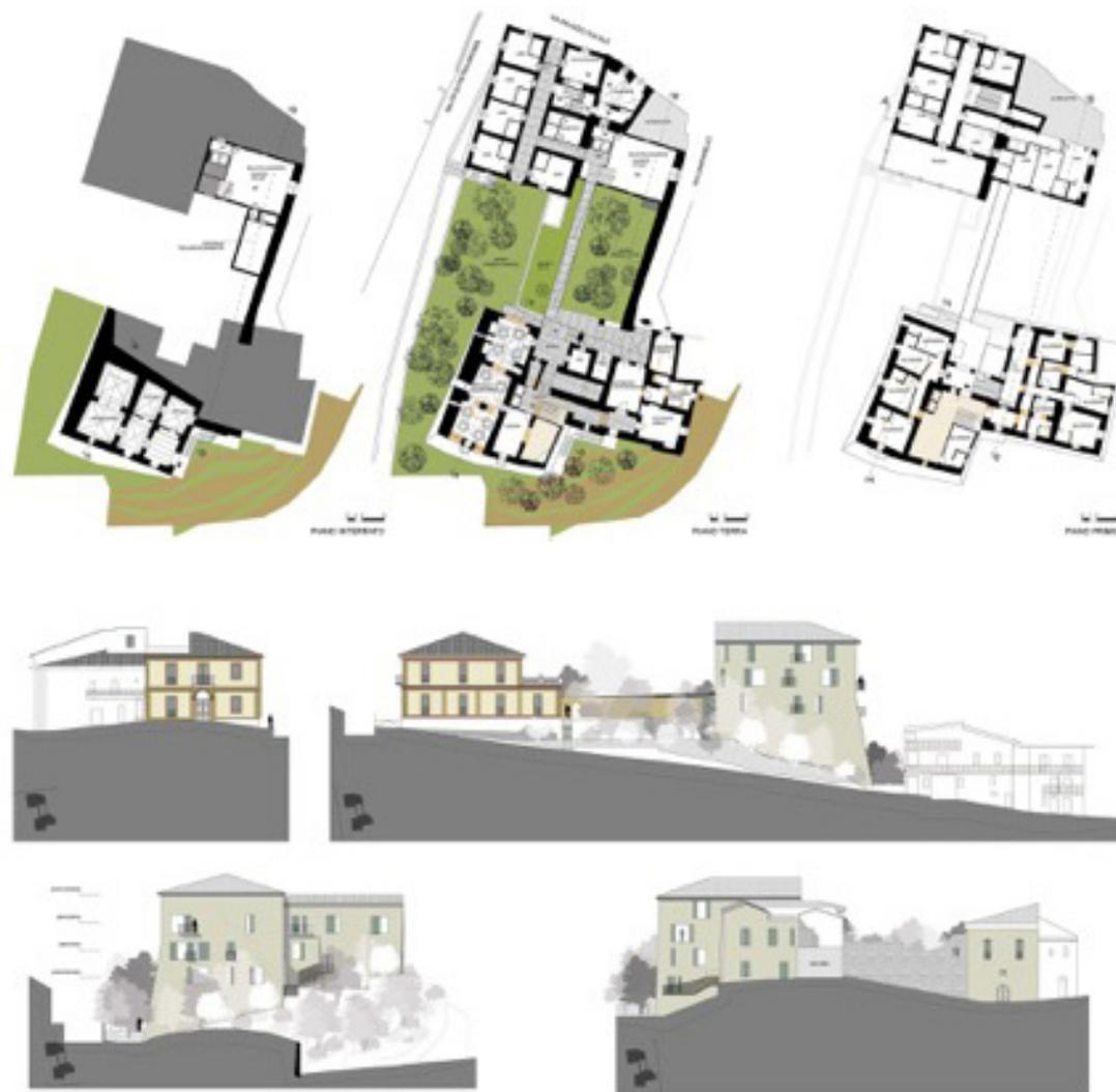
Fig.7. Piante e prospetti del complesso della nuova Casa di Soggiorno per anziani. Si noti l'approccio differenziale, con cui si è ricostruita l'immagine tradizionale del Palazzo Ducale pur evidenziando la distinzione tra paramento murario originario e ricostruito. I dettagli delle finestre, infine, sono a cavallo tra un mimetismo rifiutato e una ostentazione del contrasto di certi approcci al riuso.
