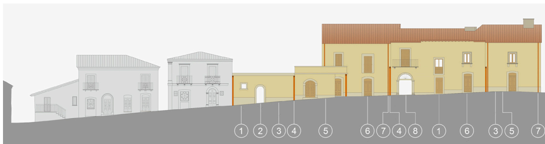
Fig.14 Estratto dal Piano di Ricostruzione: proposta di sistemazione esterna del palazzo baronale (SCUT): 1) cornici in pietra o stucco, 2) riapertura portale murato, 3) zoccolo in bronzetto di Apricena, 4) parasta in ferro corten e corpo illuminante integrato, 5) intonaco tradizionale colorato in pasta, 6) infissi in legno, 7) pluviale in rame, 8) galleria palazzo baronale.
