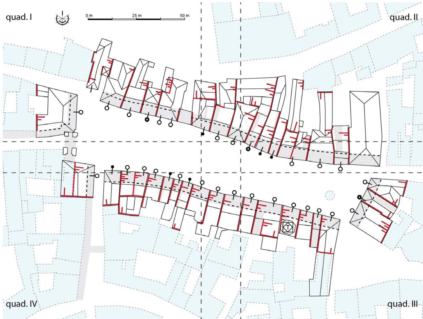
Fig. 15. Quadro d'unione relativo al caso studio della Piazza di Santarosa – Savignano: sistema resistente, conformazione geometrica e stato di fatto relativi al singolo edificio e interazione fra fabbricati attigui costituenti un aggregato omogeneo (rif. Tab. 1 – 15). (a cura di V. Donato)
