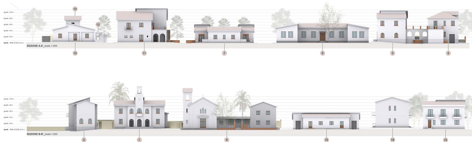
Fig. 11 - La restituzione del rilievo dei fronti degli edifici.
