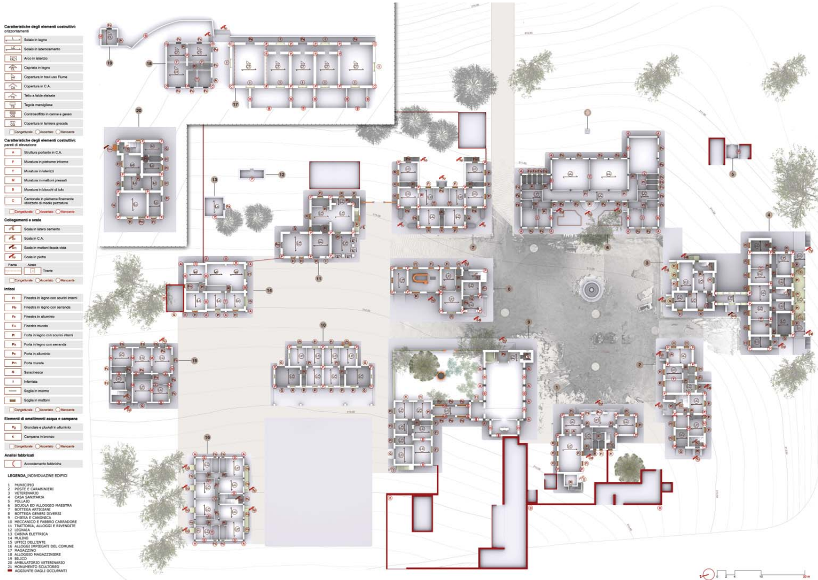
Fig. 12 - La restituzione grafica delle piante del piano terra con indicazione della distribuzione funzionale e delle caratteristiche tecnico-costruttive dell'intero borgo.
