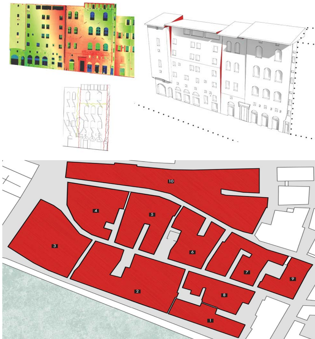
Fig.7 - Suddivisione in aggregati dopo le analisi sul tessuto urbano Fig.8 - Analisi dei dissesti di una porzione di aggregato
