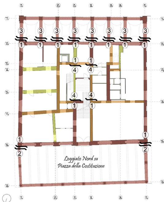
Fig. 6 Studio preparatorio per la definizione dell'Indice di Qualità di Connessione Muraria (IQCM) mediante l'analisi degli spessori dei muri, della presenza di disconnessioni murarie e dei rapporti temporali intercorrenti fra i pannelli murari.
