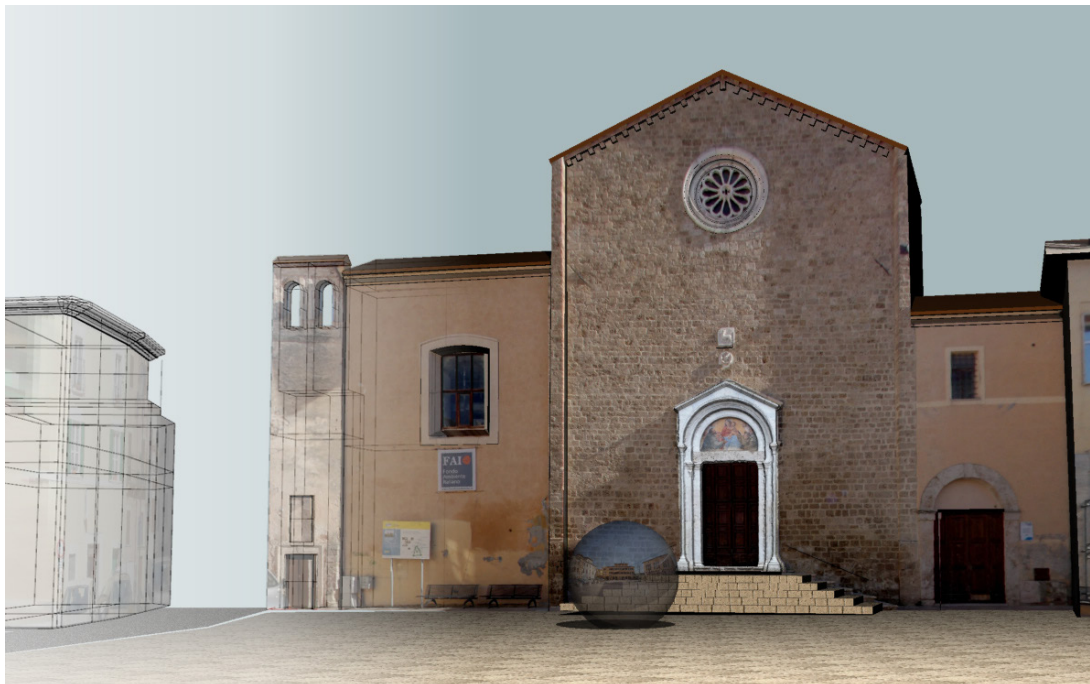
Fig.10, Piazza San Francesco a Rieti. Vista prospettica del modello matematico semplificato con l'inserimento di mesh ricavate per fotoscansione. Il modello texturizzato è stato mappato con lo stesso panorama sferico (fig. 6) utilizzato per renderizzare la points-cloud.
