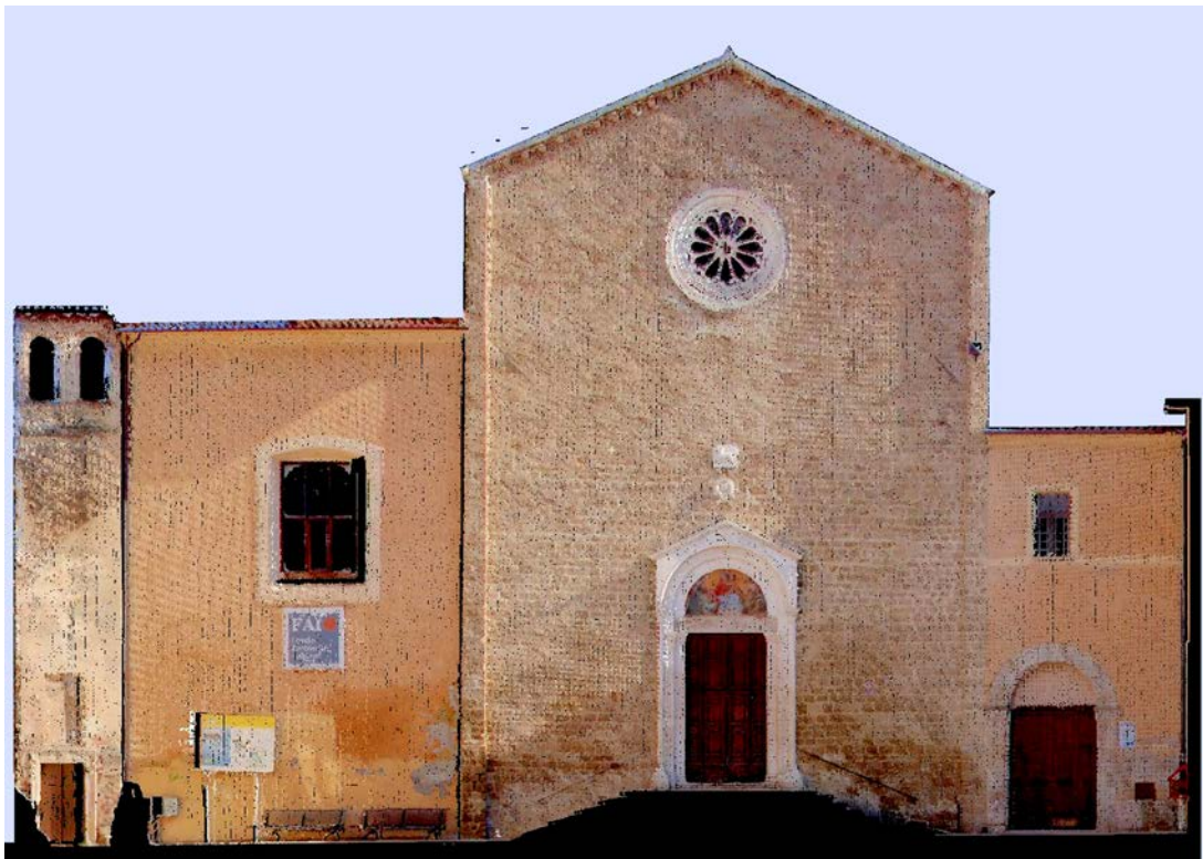
Fig.9, Piazza San Francesco a Rieti. Prospetto est. Vista ortografica ricavata dalla points-cloud renderizzata per mezzo di un panorama sferico (fig. 6) eseguito con un kit camera esterno allo scanner.
