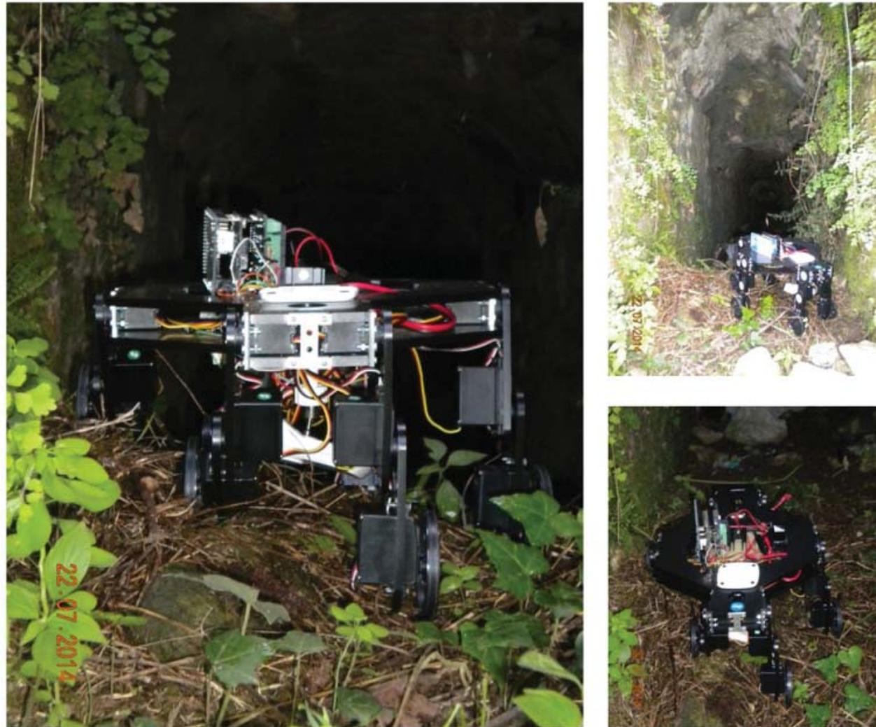
Fig. 5. Il prototipo robotizzato (HB1), accessorato con una telecamera wireless per lo studio del percorso, nel suo primo test fuori dal laboratorio LARM, nelle operazioni di ispezione di un cunicolo non accessibile da operatore umano
