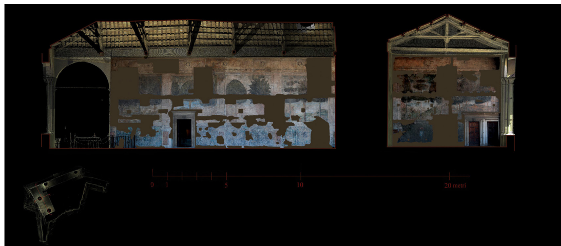
Fig. 23. Indagine sulla consistenza delle lacune degli affreschi. Rimangono tracce evidenti di un uso intensivo della loggia quando era parte del Convento.
