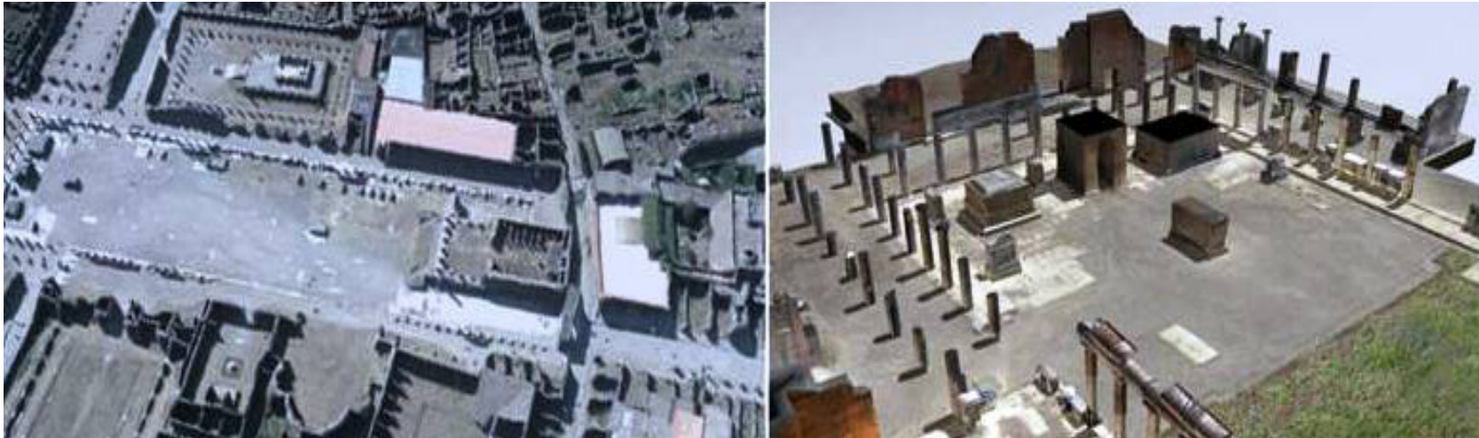
Fig. 1. F. Remondino, modello 3D del foro di Pompei, ottenuto con tecniche laser scanner e fotogrammetriche, 2009.
