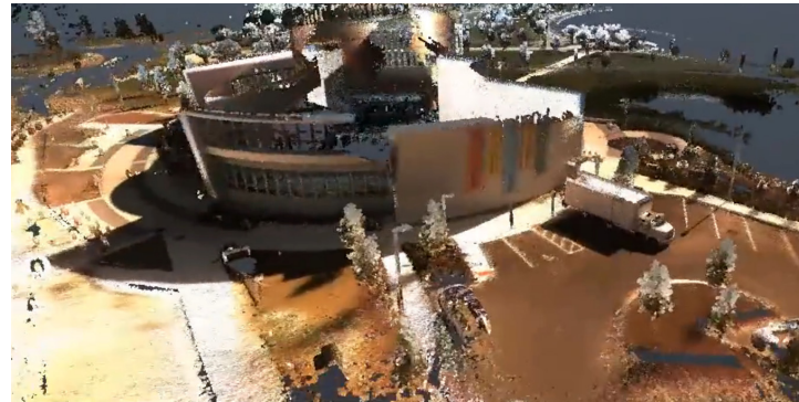
Fig 5 - Point cloud con textura realizado mediante el equipo SLAM PX80 de la firma Paracosm. Source: https://paracosm.io/px-80.html
