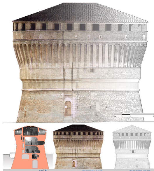
Figura 5 Elaborazioni bidimensionali dalla nuvola di punti del Torrione: dissolvenza fra ortofoto e disegno vettoriale del prospetto nord (in alto), sezioni trasversale, ortofoto prospetto nord e elaborato vettoriale del prospetto ovest.
