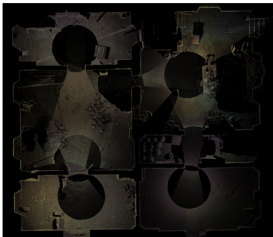
6. La nuvola di punti delle piante al piano seminterrato.
