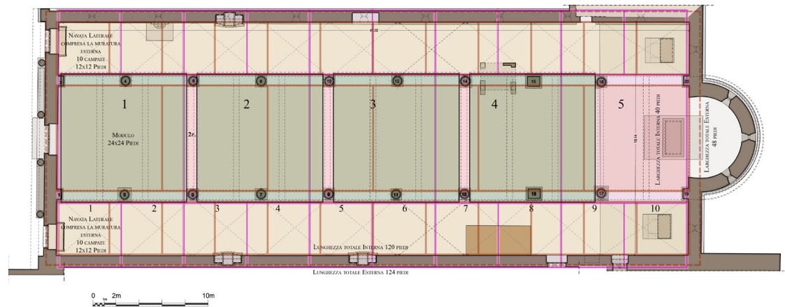
Sopra Fig.12- Planimetria generale di San Bartolomeo con graficizzate le considerazioni riguardanti le dimensioni generali e i moduli di riferimento. In arancione la scansione di base (6 moduli la navata centrale e 12 quelle laterali). In rosa i moduli di 12x12 piedi e 24x24. In verde i moduli di 24 piedi individuano, nella navata centrale, lo spazio di due vuoti e un pieno.
