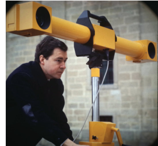
Fig. 11 - Antonio Almagro con la cámara estereofotogramétrica SMK 120 del Ministerio de Cultura del Gobierno de España, 1985.
